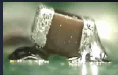
焊锡两端牵引 力不一致，右 侧向外牵引力 大，左端翘起
